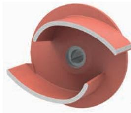
Открытое двухканальное колесо (Q) с автоматическим устройством волоконного среза для перекачиваемых сред с твердыми частицами – для особо щадящей перекачки. Высокая равномерность вращения достигается благодаря симметричной форме.
